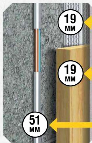
Обнаружение проводов с переменным током на глубине до
