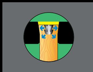
**ПРОЧНОЕ СОЕДИНЕНИЕ ГОЛОВКИ И РУКОЯТКИ**
