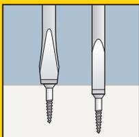
Существуют два вида жала отверток под прямой шлиц: расширяющееся и параллельное. Для большинства задач подходит первый из них, однако в случаях, когда винт требуется заглубить, не повредив поверхность детали, потребуется отвертка с параллельным жалом, шириной, равной диаметру головки винта. Всегда следует выбирать отвертку с размером жала, соответствующим размеру шлица винта. Слишком широкое жало повредит поверхность материала, слишком узкое может повредить шлиц винта.
